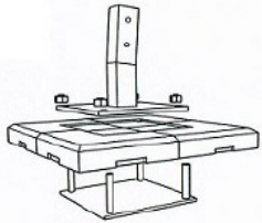
Base de bloques de hormigón
